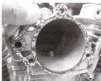
①キャブに直接ステーをセットするのではなく、しっかりとガスケットを挟む。
